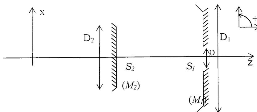
Figure 2 : *Télescope du VLT en configuration Cassegrain*
